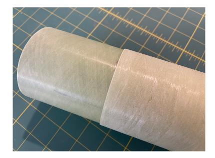
6) INSERT THE COUPLER INTO THE NOSECONE UP TO THE MARKED HALFWAY POINT.
